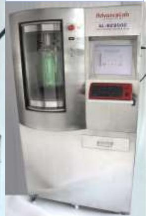
El Suministro de aire de alta presión y agua independiente, interno e integrado, elimina la Necesidad de un suministro de nitrógeno líquido externo engorroso.
